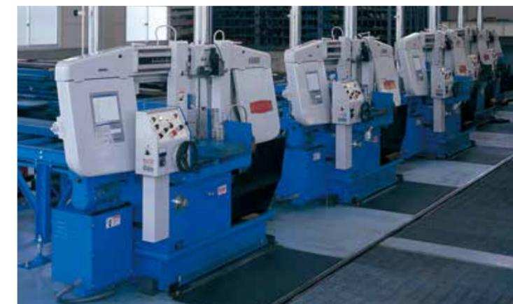
平鋼切断専用鋸盤
